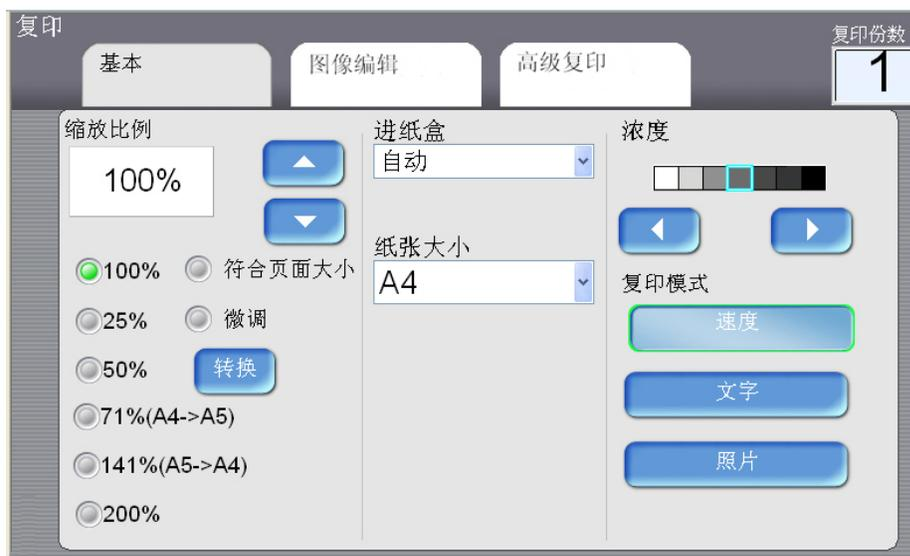
3. 如果你想要增加复印张数，请用面板上的数字键来输入你需要的份数。复印的份数会显示在液晶屏幕的右上角。
