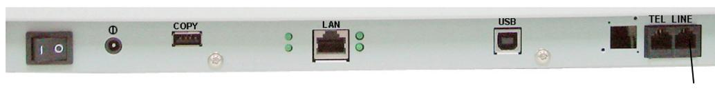
2. 另一端插入“RJ-11”电话公司所提供的电话孔。
