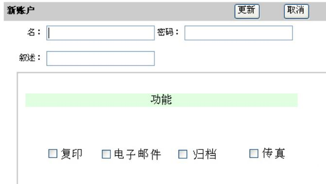
8. 在名称及密码字段内，分别输入登录名称与密码。登录名称与密码有大小写的区分，登录名称最多可以输入 64 个字符，密码最多可以输入 16 个字符。如果需要，请在叙述字段输入文字。
