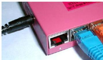
2. 另一端插入本产品背面标有“LAN”的网络连接端口。
