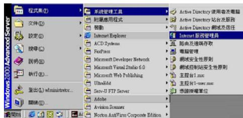
2. 点选“预设的 Web 站台”，按鼠标右键，再按内容，“预设的 Web 站台内容”对话框会显示。 点选“Web 站台”，记下 SSL 连接埠。
